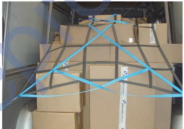
Dieses Netz besteht aus einem feinmaschigen Seilnetz, das fest mit einem grobmaschigen Gurtnetz verbunden ist.
