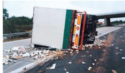
Die ungesicherten palettierten Dosen rutschten beim Auffahren auf die Autobahn in die Seitenplane, das gesamte Fahrzeug geriet aus dem Gleichgewicht und stürzte um.
