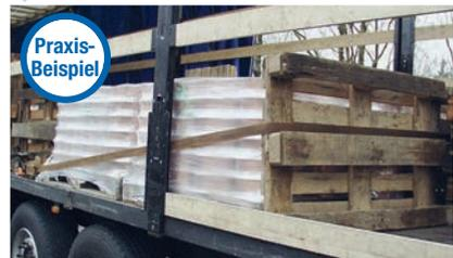
Bei Umreifungszurren (z.B. einer Kopfschlinge) verläuft das Zurrmittel von einem Zurrpunkt auf der Ladefläche kommend um die Ladung herum und zurück zu einem anderen Zurrpunkt auf der Ladefläche. Hier ist die Zurrkraft in der Umreifung (z.B. 5.000 daN) entscheidend. Daher kann der als Zurrkraft im geraden Zug (z.B. 2.500 daN) angegebene Wert verdoppelt werden.
